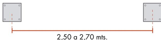
B - Se deberá marcar la ubicación de los 4 agujeros elegidos para fijar la placa a la pared y realizar los agujeros con un diámetro de 10 mm y una profundidad no menor a 100 mm.
